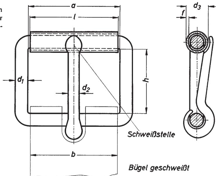
Bezeichnung einer Rollsnalle für Riemenbreite  $b = 40$  mm aus Stahl (St), Ausführung vernickelt:
